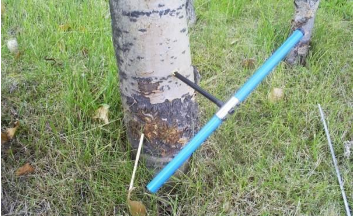
Mynd 5. Sýnataka úr öspum með áhringjabor í 0,3 m hæð frá yfirborði.
